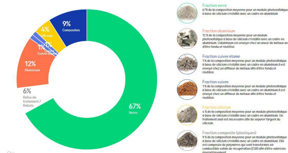
Figure 22 : Différentes fractions composant un panneau photovoltaïque (source : SOREN)
