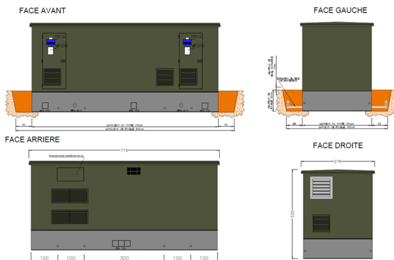
Figure 19 : Poste de livraison
