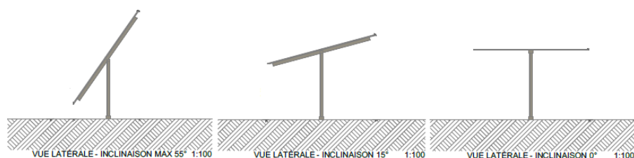
Figure 17 : Exemple d'une structure photovoltaïque au sol
