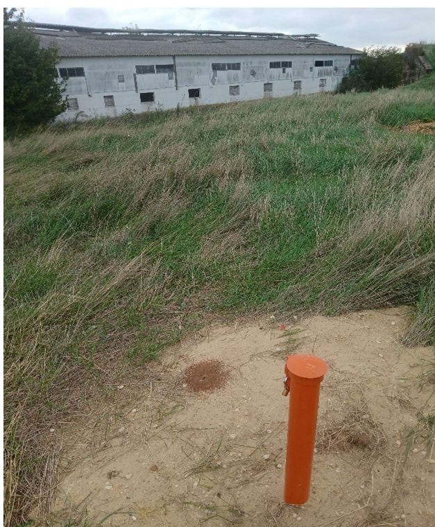
Photos du piézomètre et de son environnement proche
