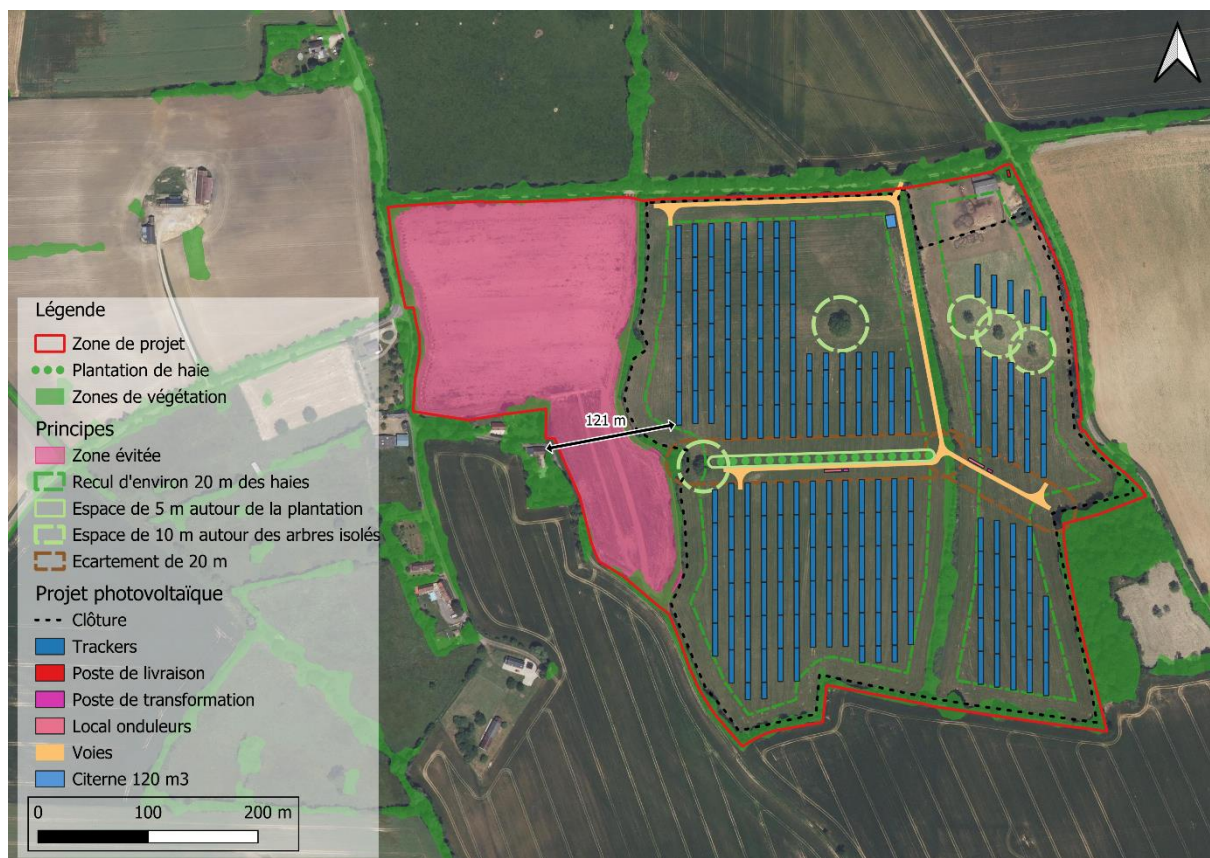
Figure 16 : Principe de dimensionnement des trackers par rapport aux éléments végétaux
