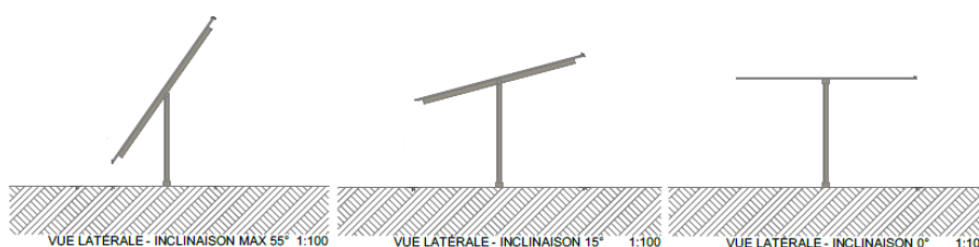
Figure 15 : Exemple d'une structure photovoltaïque au sol
