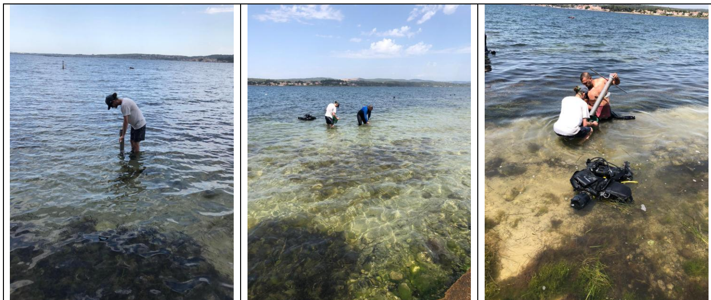
Prélèvements de sédiments à l'aide du carottier manuel
