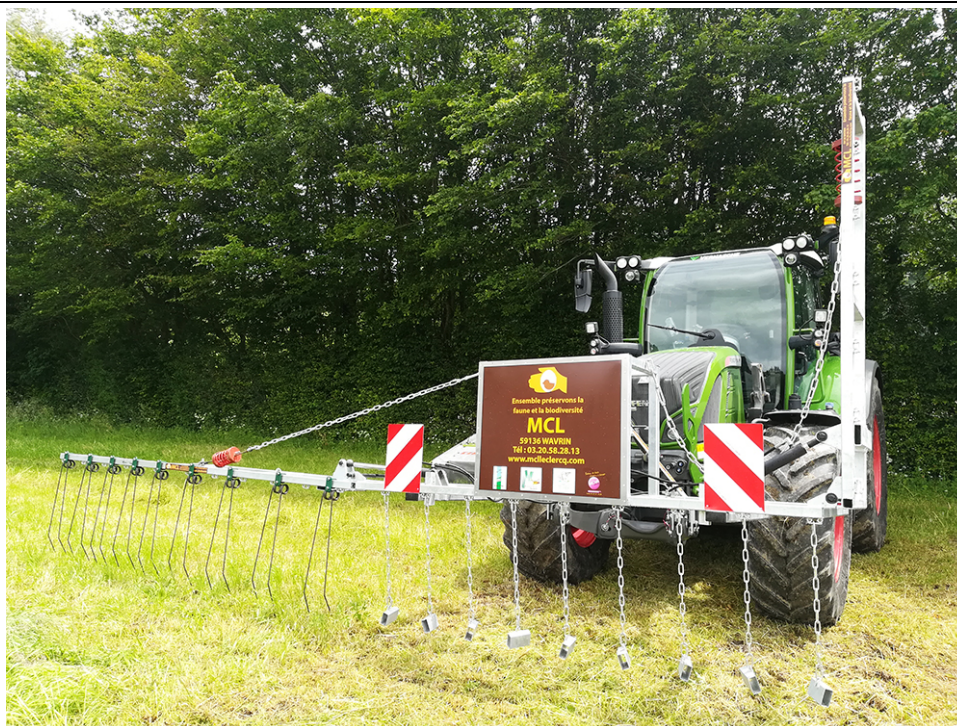
Barre d'effarouchement attelée à l'avant d'un tracteur (Source : barre-effarouchement.fr)
