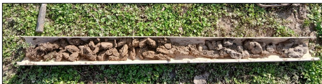
Sondage n°5, Caractéristique (GEPPA IVd)
