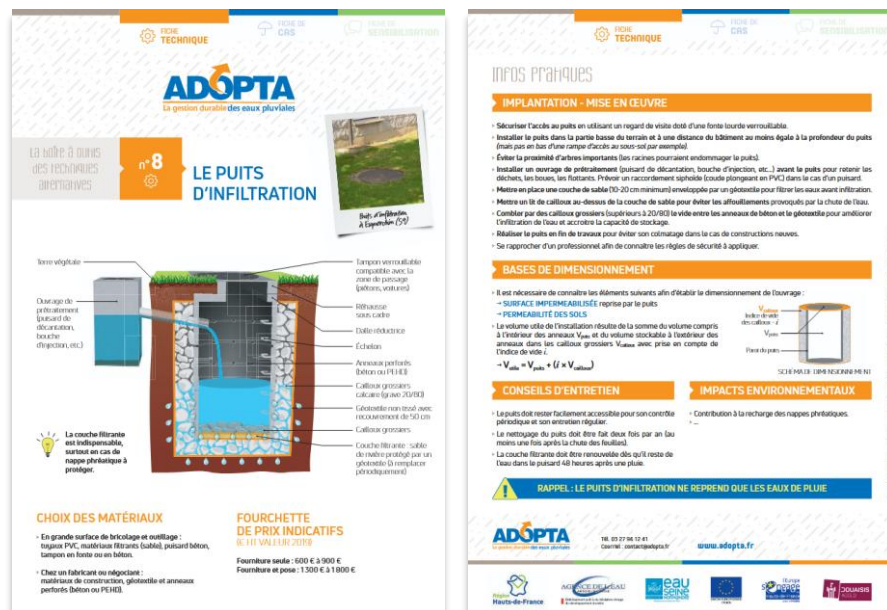
Figure 17 : Fiche technique ADOPTA n°8 — Puits d'infiltration (implantation, bases de dimensionnement, entretien)
