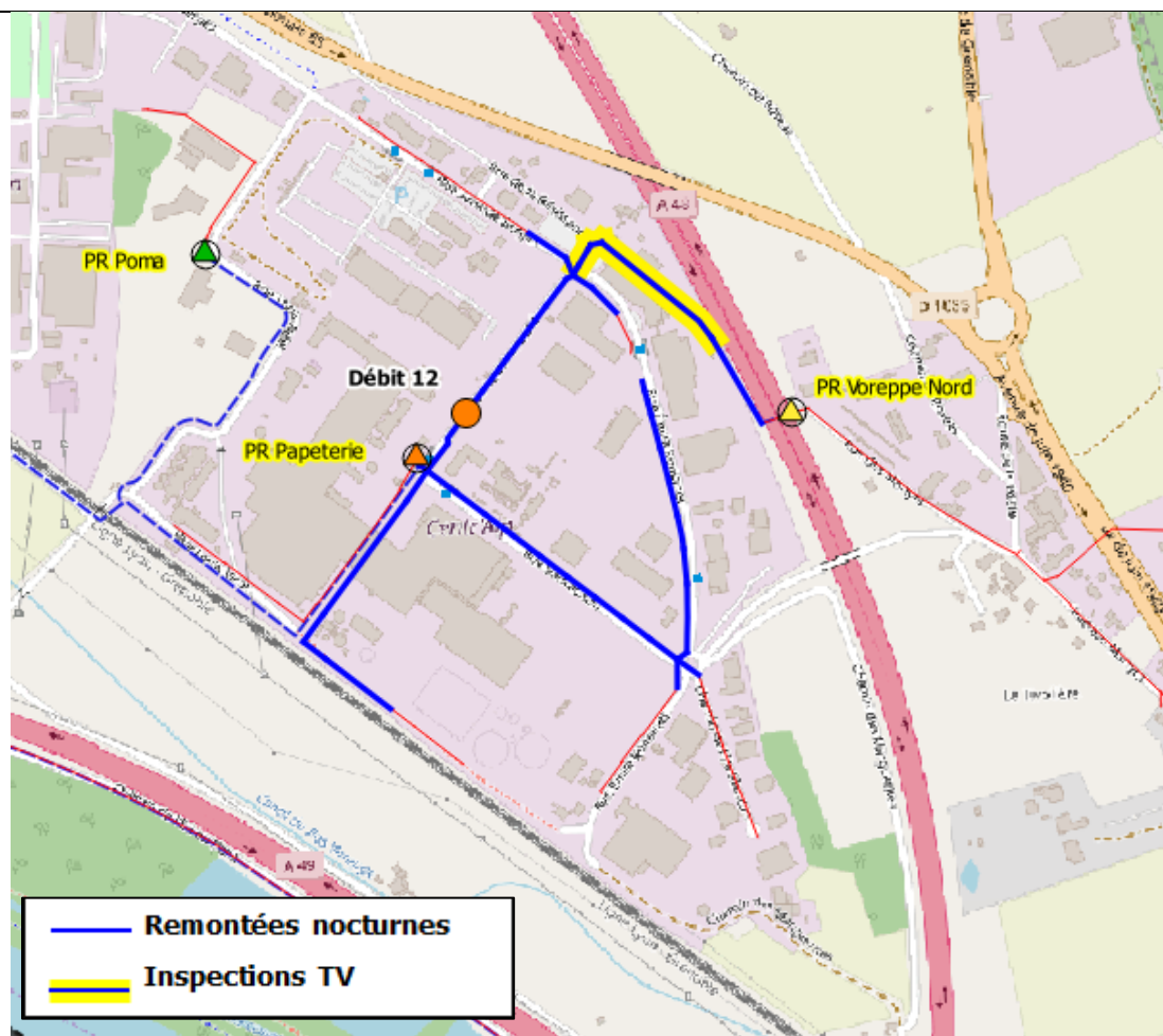
FIGURE 32 – TRONÇONS PARCOURUS LORS DES REMONTEES NOCTURNES ET ITV – SECTEURS AMONT PR PAPETERIE A VOREPPE
