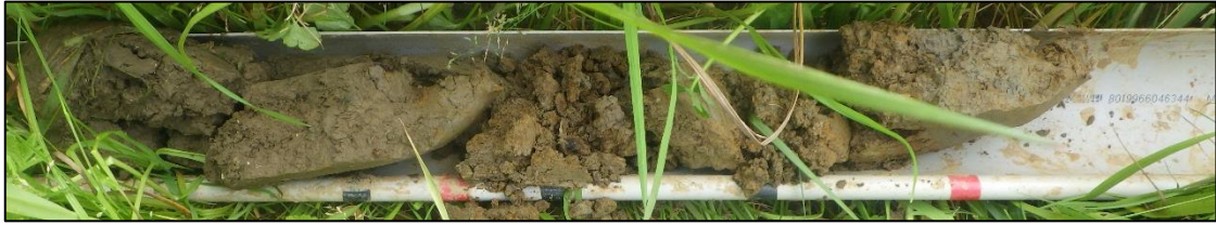
Sondage n°2 : Apparition des traces rédoxiques à 0,20 m, s'intensifiant à la suite, avec un refus à 0,55 m de profondeur (Classe Va).
