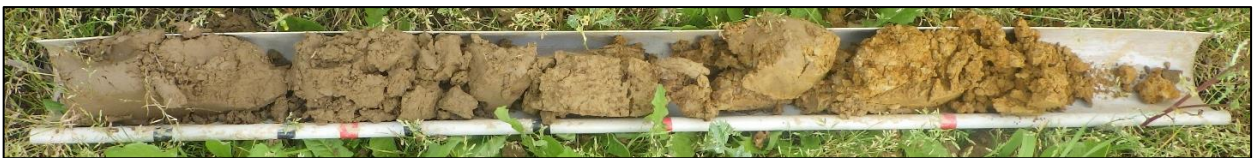
Sondage n°29 : Apparition des traces rédoxiques à 0,35 m, s'intensifiant à la suite avec un refus à 0,90 m de profondeur (Classe IVa)
