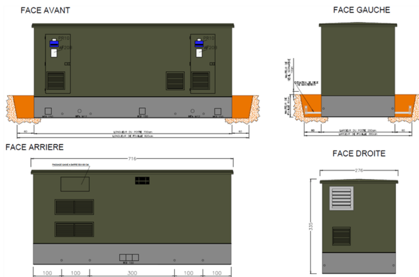
Illustration 6 : Poste de transformation
