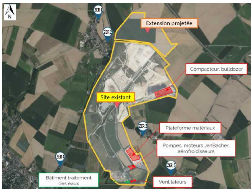
Figure 8- Localisation des différentes sources de bruit induites par le projet et localisation des points de mesures localisées dans les ZER (EI, p.157)
