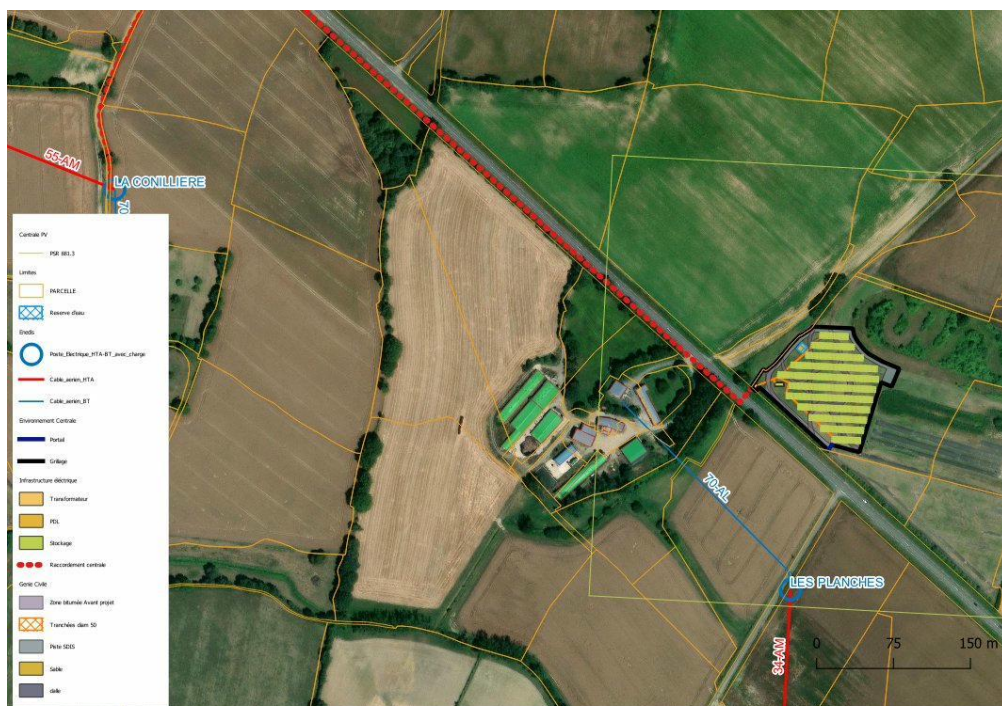
Figure n°11 : Raccordement de la centrale et du BESS
