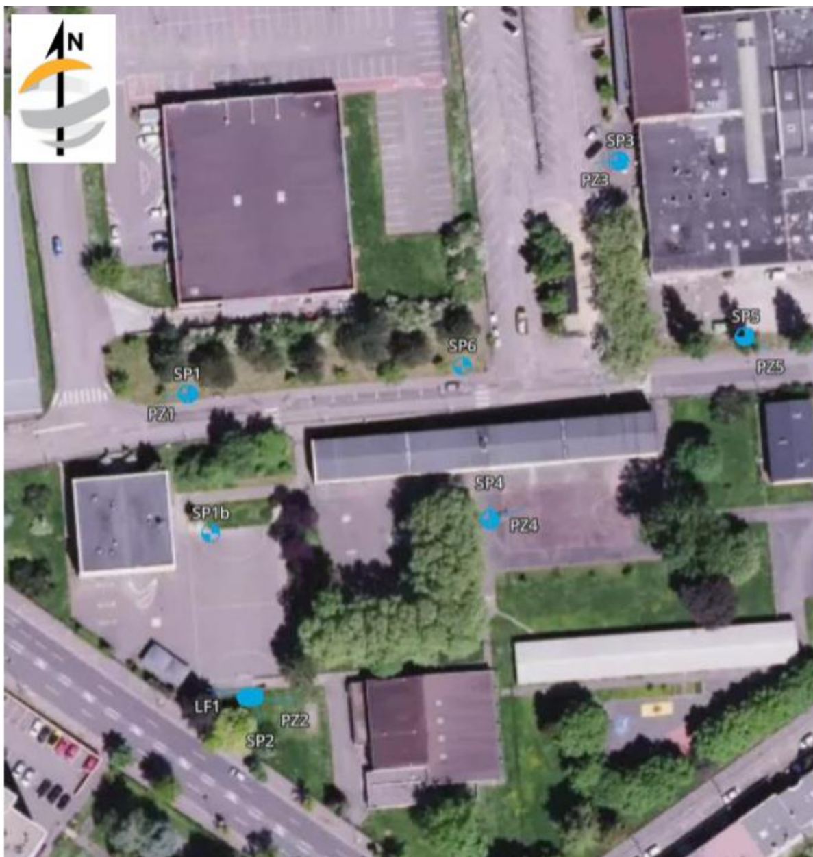
Figure 6 : Localisation des sondages (Source : Fondasol)
