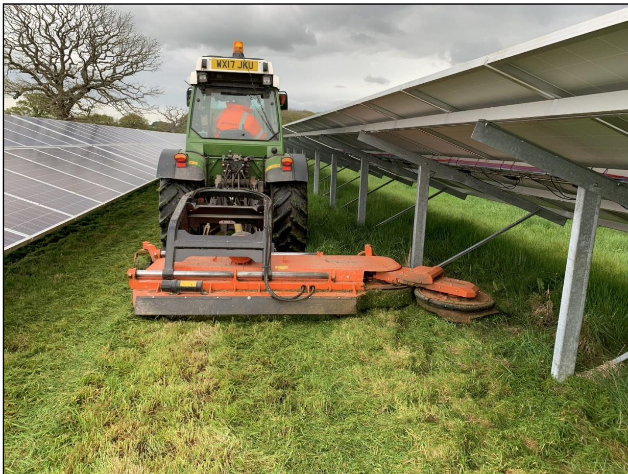
Figure 22 : Exemple de faucheuse pour parc solaire (Source : SUNSWING)
