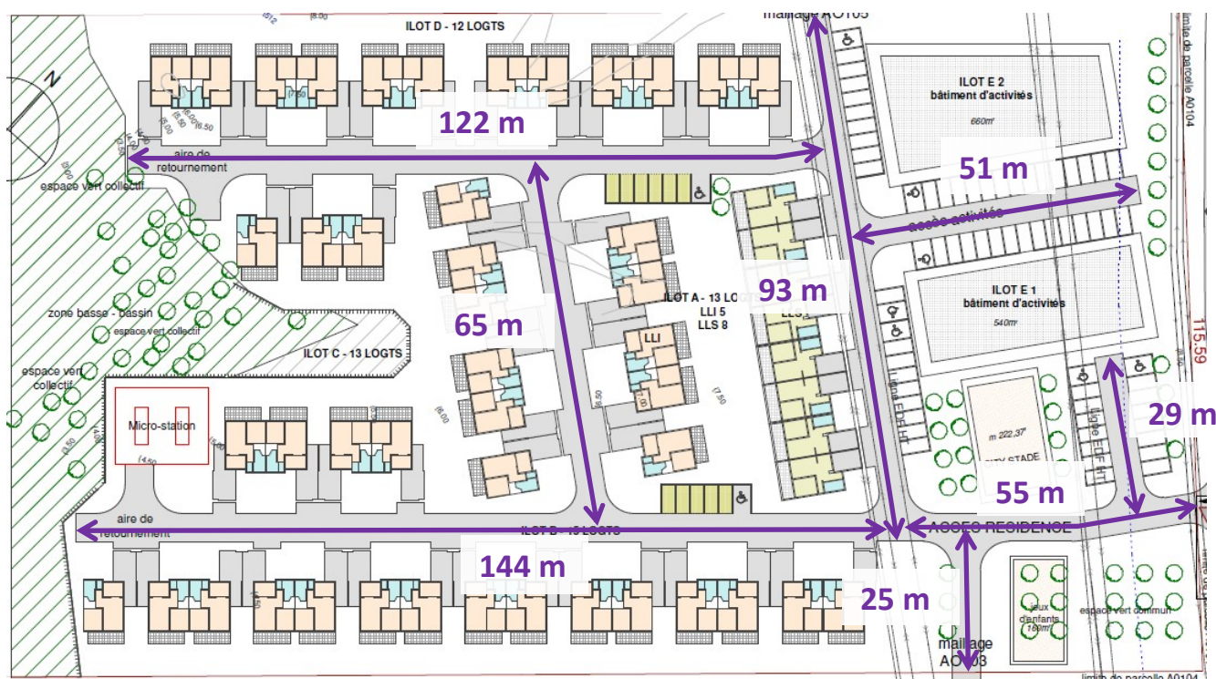
Figure 5 : Longueur des voiries créées
