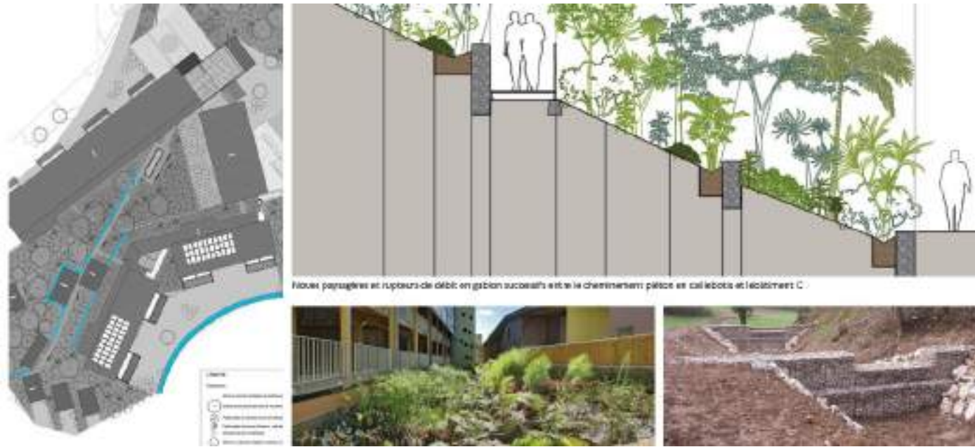
Figure 8 : Disposition des noues et principe de fonctionnement – source : LEU, 2024
