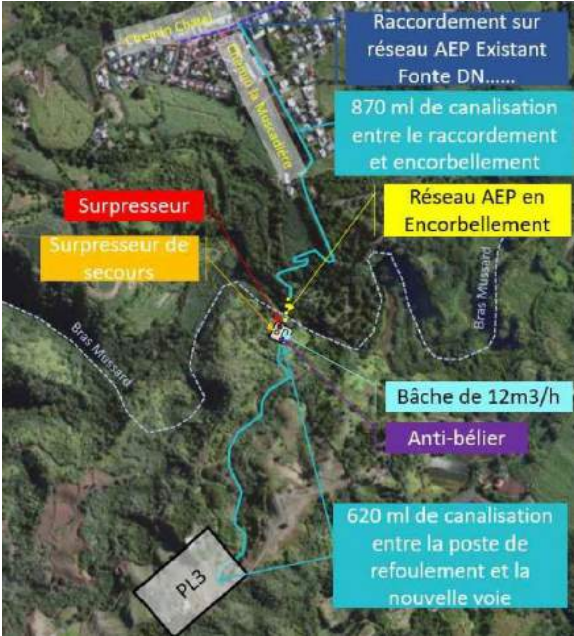
Figure 9 : Raccordement en eau potable au niveau de la piste – source : LAB-LEU, 2024
