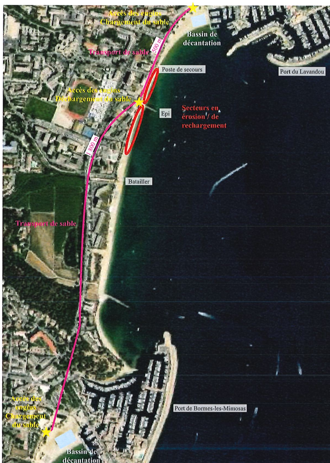
Figure 15 : Plan du transport, chargement et déchargement du sable, depuis les ports du Lavandou et de Bormes-les-Mimosas, pour le réensablement de la plage du centre-ville du Lavandou
