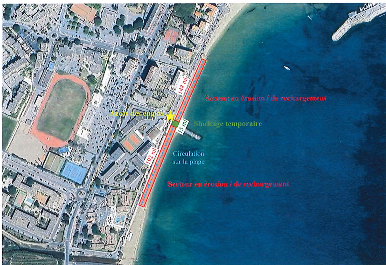
Figure 16 : Plan détaillé de la méthodologie de réensablement entre le poste de secours et le Batailler
