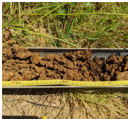
Figure 3 - Exemple de traces de rouilles
