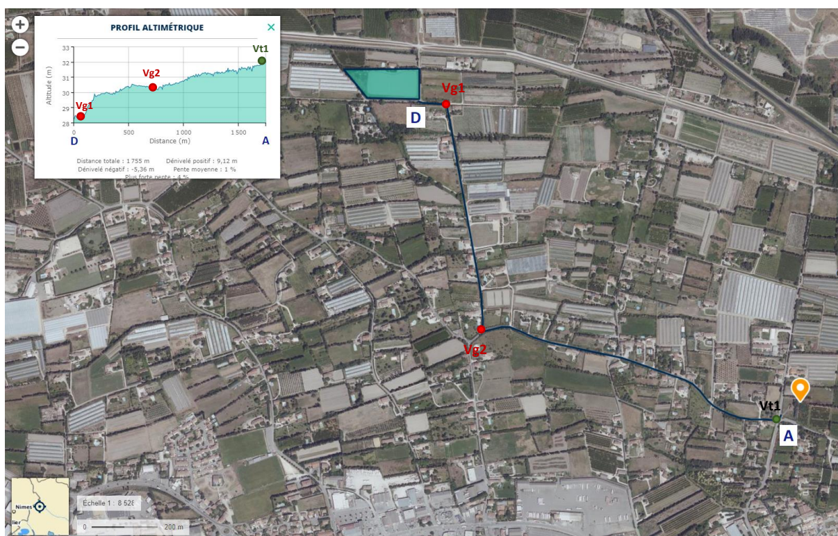
Figure 14. Tracé et profil de la solution n°1 (extrait géoportail)
