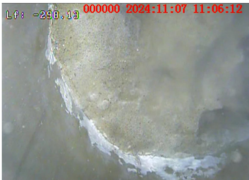
Figure 15: Remplissage du tube de décantation par un bouchon de ciment de plusieurs dizaines de centimètres (forage F2).
