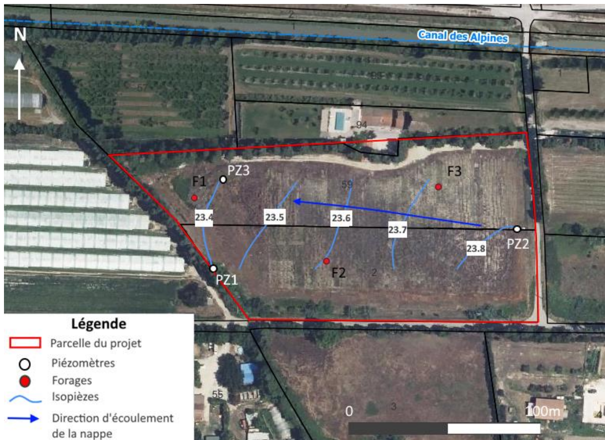
Figure 25 : Carte piézométrique à l'état statique - 14 septembre 2024
