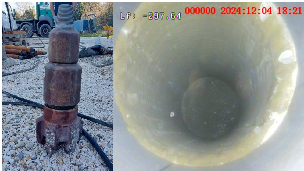
Figure 21: Elargissement du bouchon de ciment au PDC.
