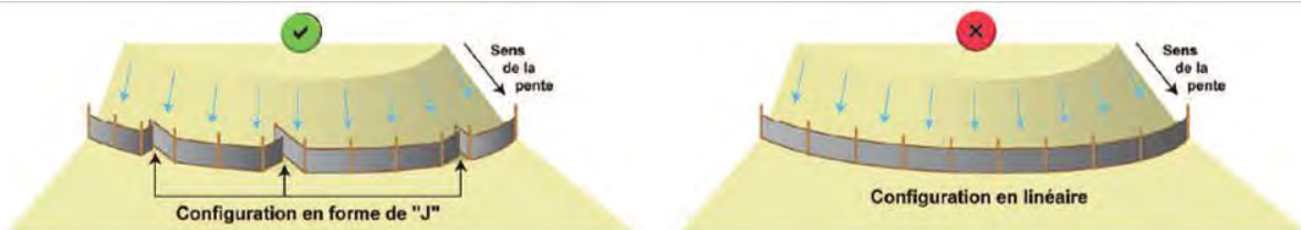
Figure 38. Lors d'un chevauchement de deux barrières, enrouler le géotextile autour des piquets avant de les planter. Ceci assure une continuité sans interstice entre les deux sections. Source : Tetra Tech.
