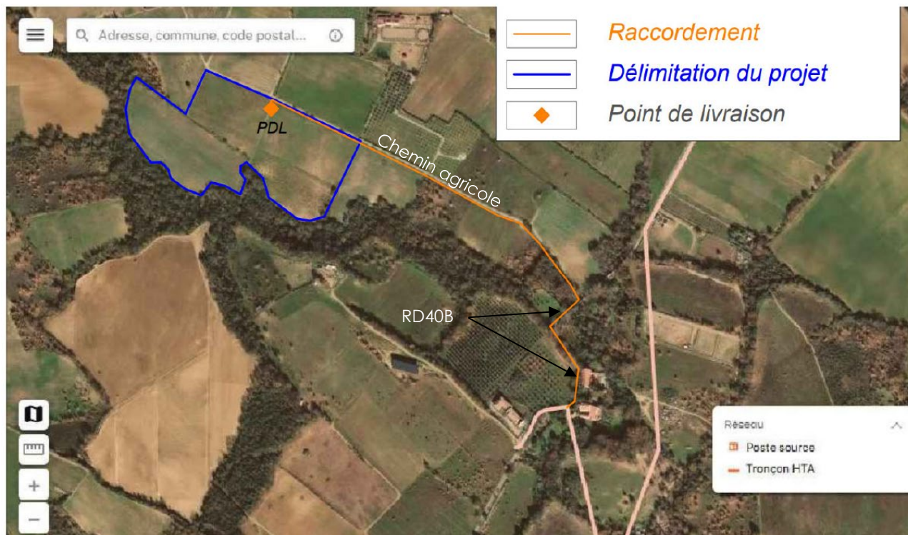
■ Carte 6 : Tracé du raccordement au réseau électrique
