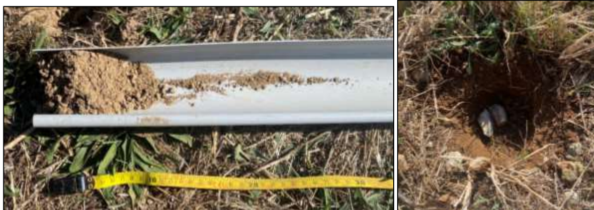
Photo 3 : Sondage 4 (à gauche), éléments grossiers (à droite)
