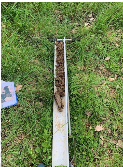
Figure 7 : photographie du sondage tarière
