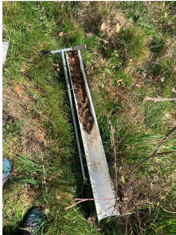
Figure 8 : photographie du sondage tarière
