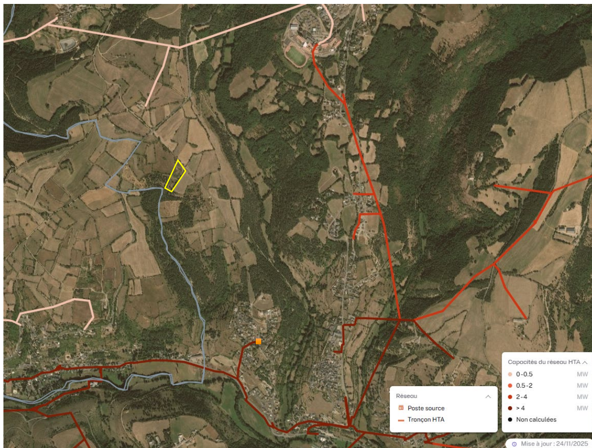
FIGURE 24 : CAPACITE DISPONIBLE SUR LES LIGNE HTA DE PROXIMITE – SOURCE : ENEDIS
