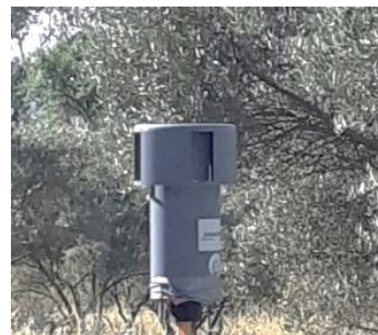
Figure 40 : Principe de l'échantillonneur passif Passam - \text{PM}_{10}
