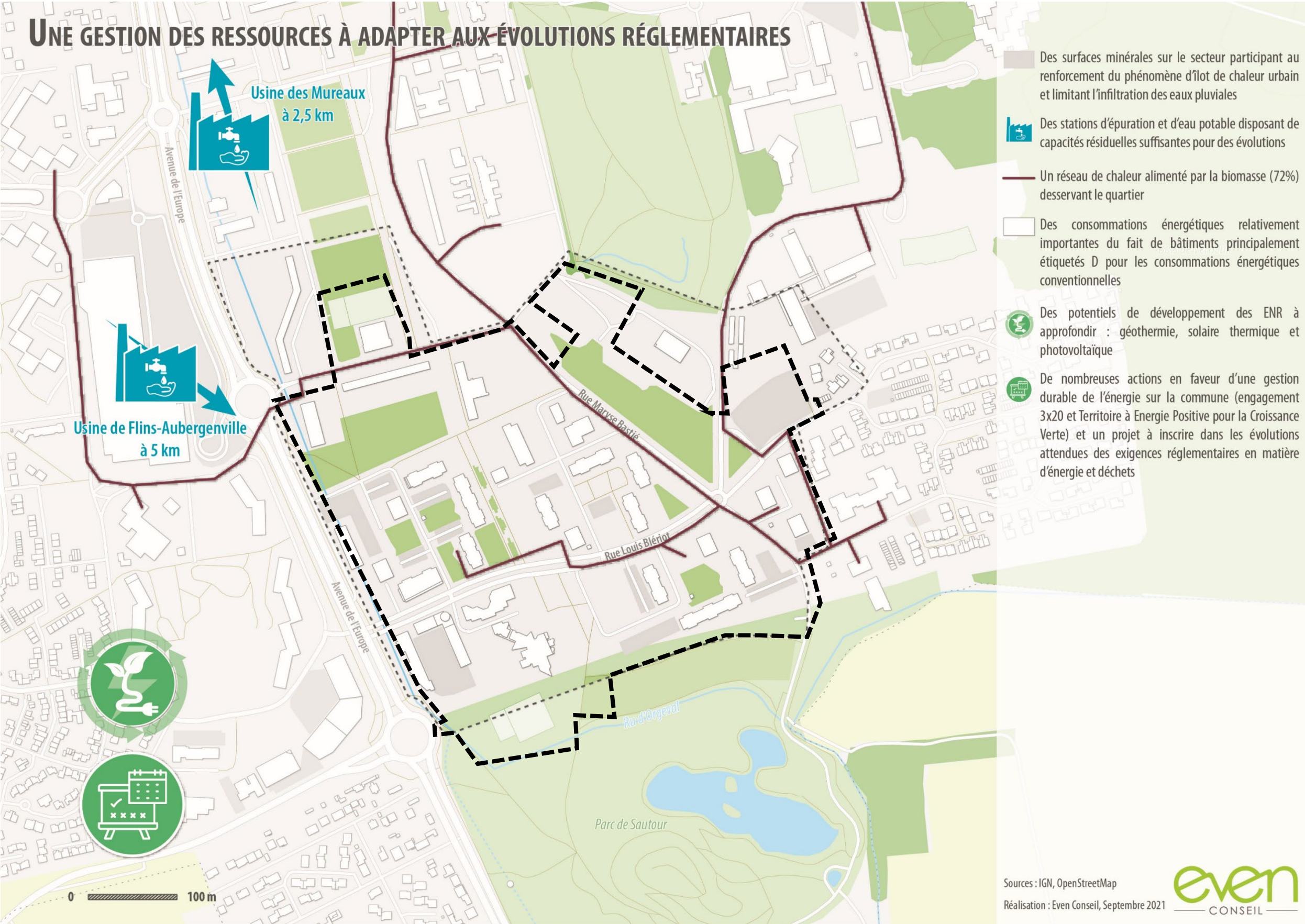
Figure 15 : Cartographie d'enjeux relatifs aux thématiques gestion de l'eau, énergie, et gestion des déchets – source : Even Conseil 2021
