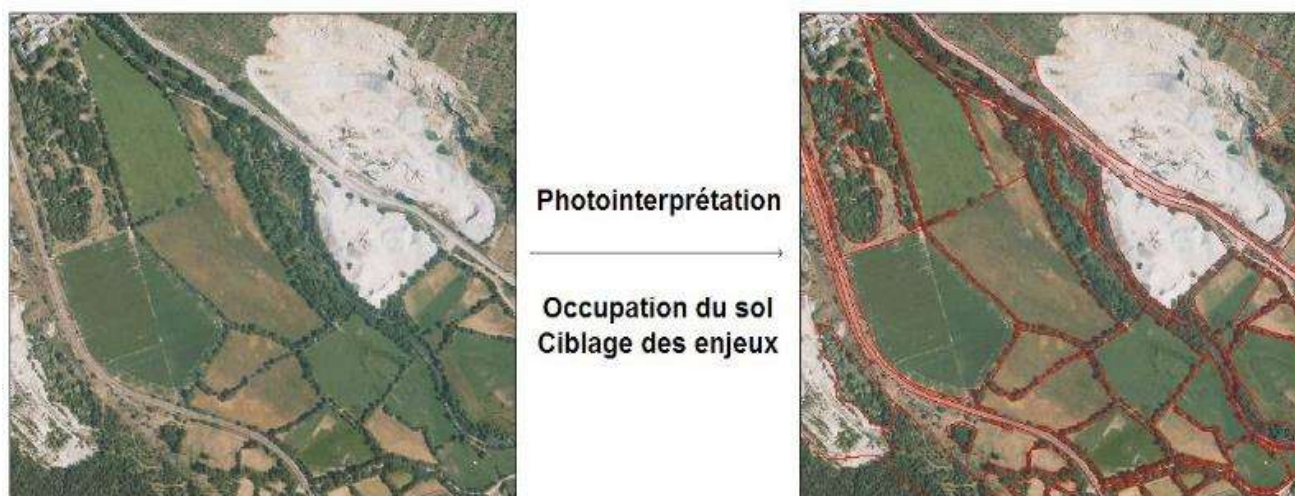
Figure 6 : Schéma de principe de la précartographie
