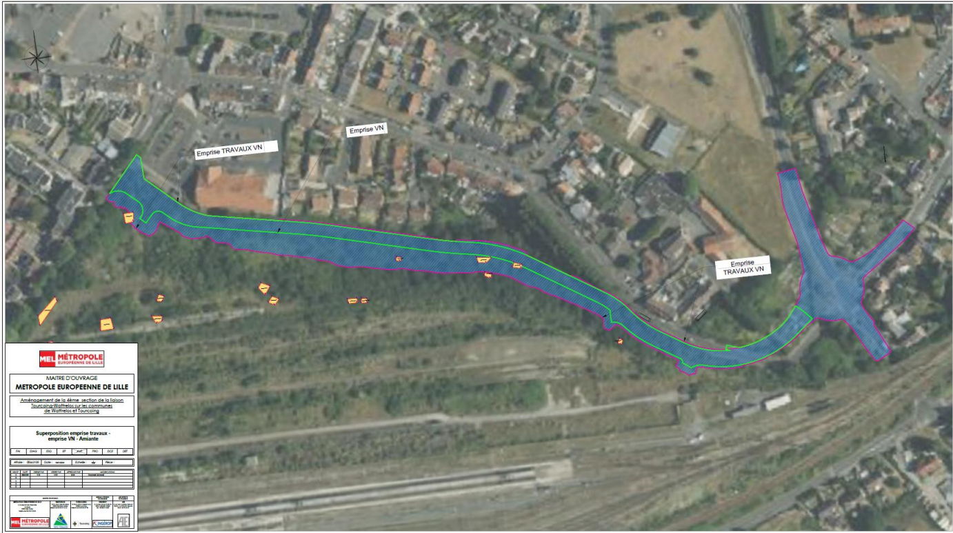
Figure 30 : Localisation des objets contenant de l’amiante (orange) par rapport à l’emprise voie nouvelle (vert) et l’emprise travaux voie nouvelle (rouge), d’après l’étude Socotec 2026, cartographie Ingérop.
