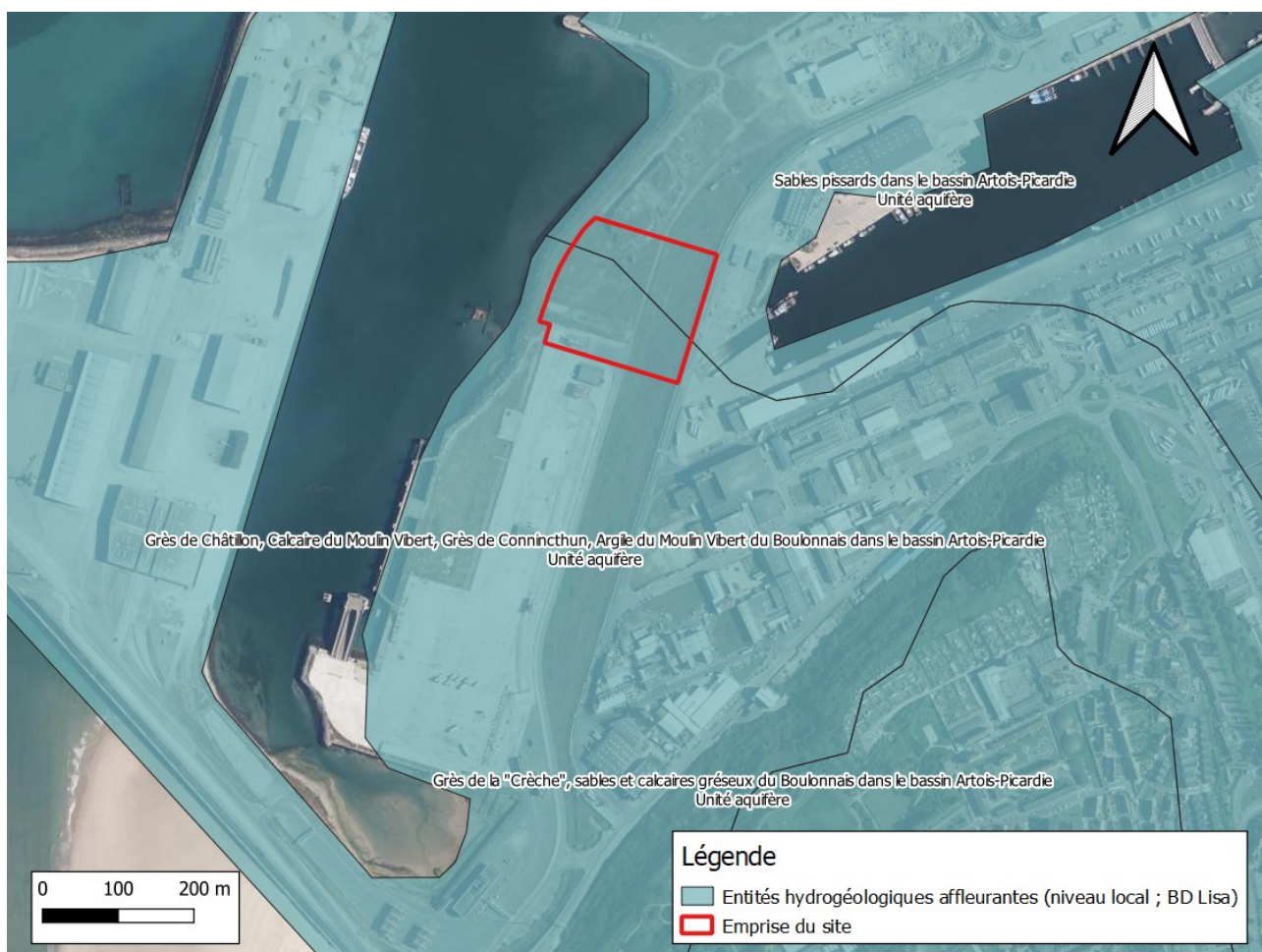
Figure 9 : Nappes affleurantes passant au droit du site
