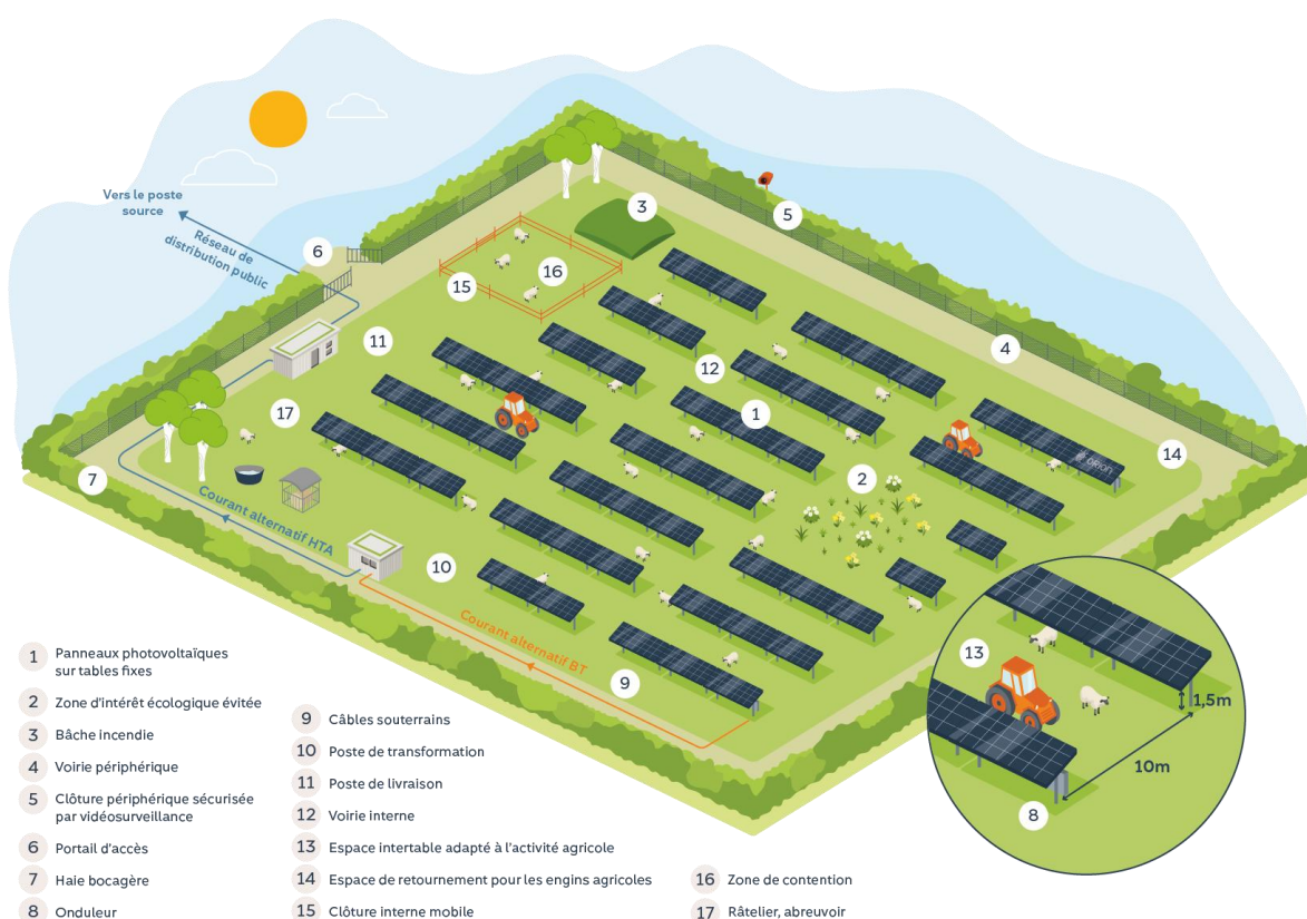
Schématisme d'un parc d'ombrières agrivoltaïques en co-usage avec élevage ovin
