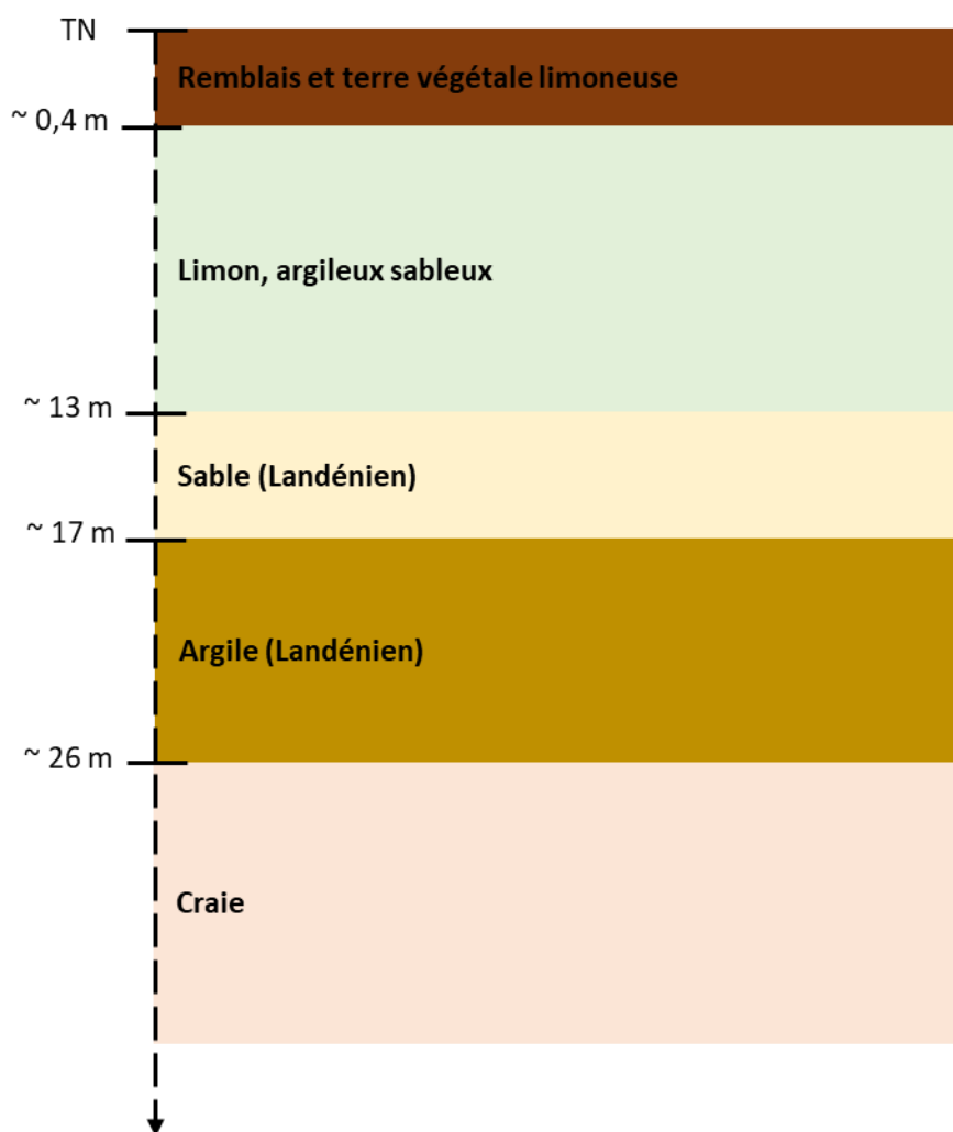
Figure 11 : Coupe géologique schématique au droit du site d'étude (sans échelle)
