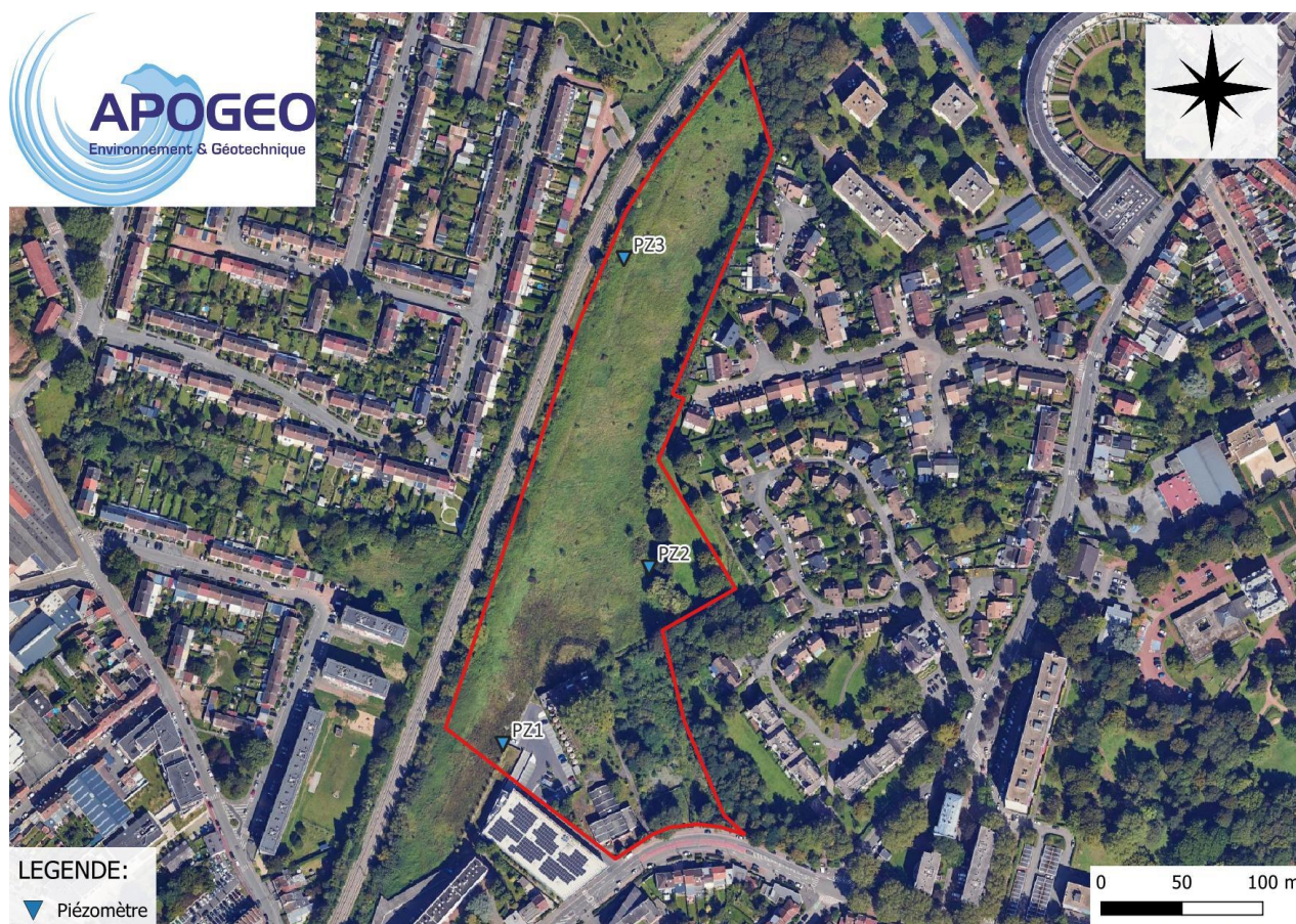
Figure 18 : Localisation des piézomètres monitorés
