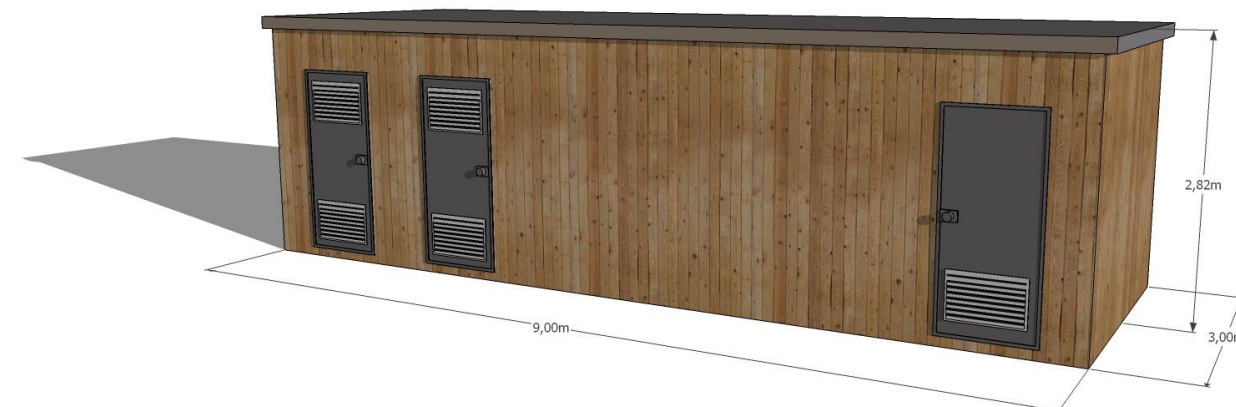
Figure 1 : Dimensions et bardage du poste de livraison (Source : BE Jacquel et Chatillon)
