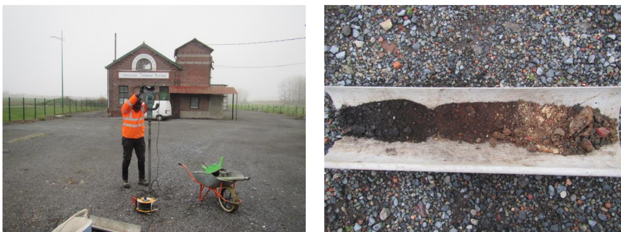
Figure 15 : Technique de forage au carottier portatif à gouges
