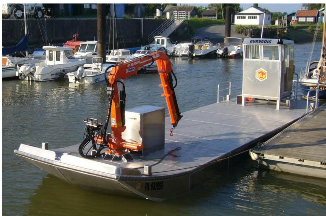
Exemple d'une barge à fond plat pour placer les récifs artificiels
