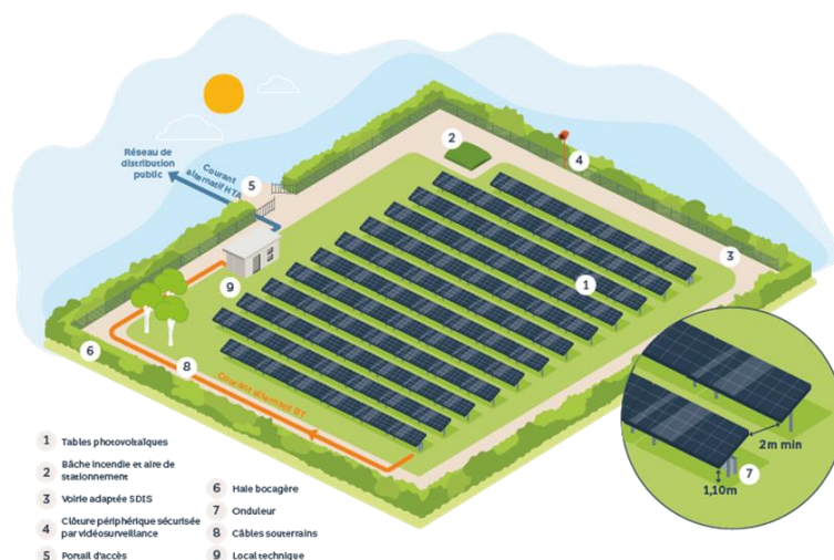
Figure 1 : Schéma de principe d'un parc solaire PV
