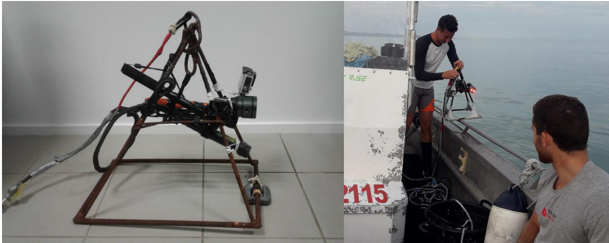
Figure 4 : Structure métallique équipée de deux caméras et d'un phare – TBM environnement
