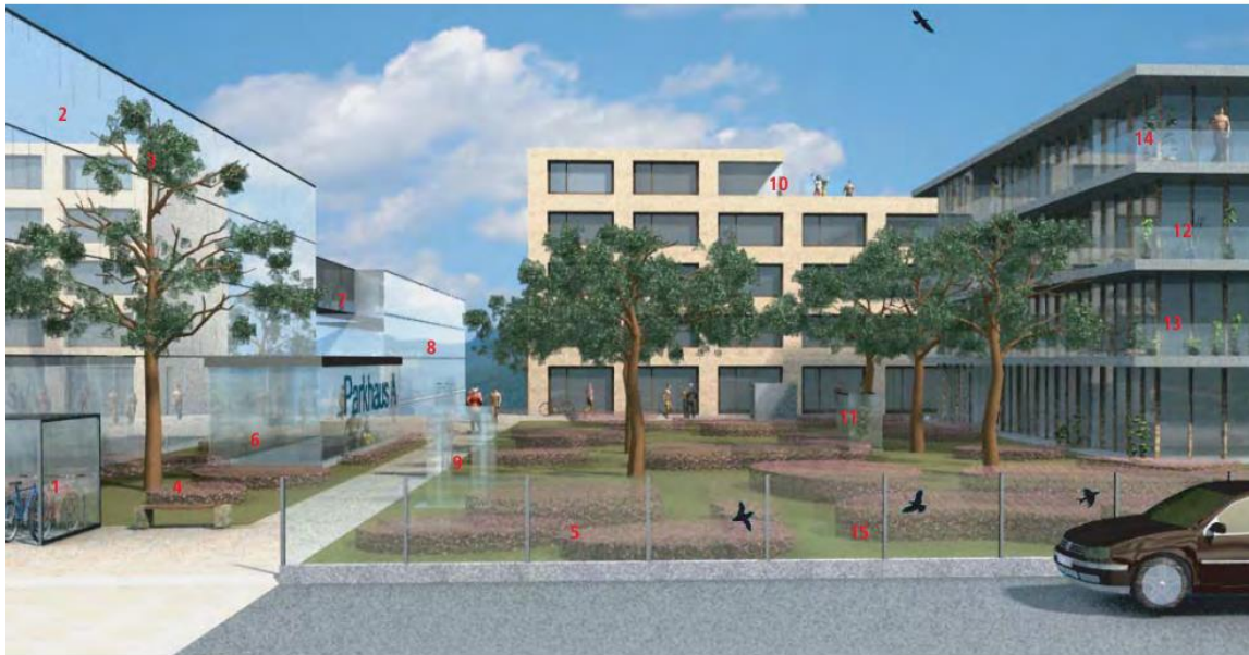
Vue d'ensemble des dangers existant dans un lotissement moderne : 1 abri pour vélos en matériel transparent, 2 façades réfléchissantes (verre, métal, etc.), 3 arbres devant une façade réfléchissante, 4 surfaces vertes attractives devant une façade réfléchissante, 5 paroi antibruit transparente, 6 accès au garage muni de verre, 7 passerelle transparente, 8 façade réfléchissante, 9 sculptures en matériel réfléchissant ou transparent, 10 angle transparent, 11 jardin d'hiver transparent, 12 balustrade de balcon en verre, 13 angles transparents, 14 végétation derrière des surfaces transparentes, 15 silhouettes de rapaces très espacées. La page 15 montre comment ce lotissement pourrait être conçu de façon à ne pas poser de problèmes aux oiseaux.
