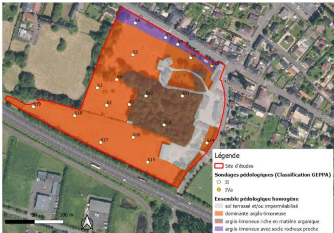
Figure 11 : cartographie de la localisation des sondages et identification des grands ensembles pédologiques homogènes selon le diagnostic de zones humides réalisé par IAO SENN.
