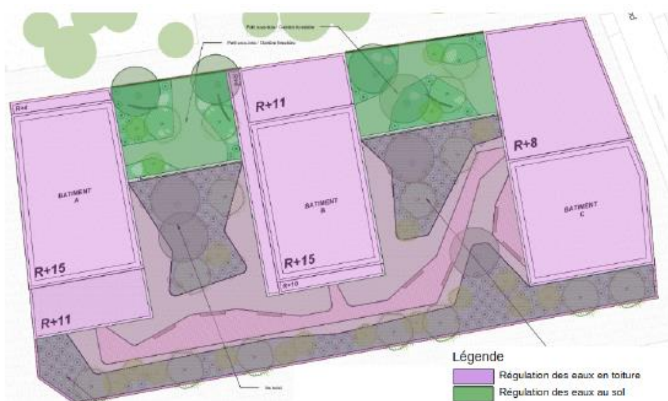
Figure 4 : Répartition de la gestion des eaux pluviales en application du zonage pluvial de Rennes Métropole
