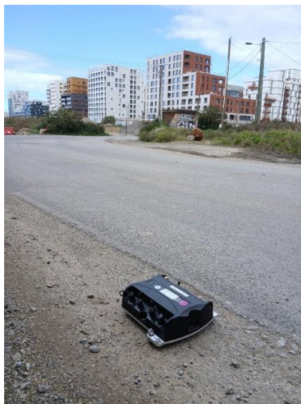
Figure 7 : Photographie du point de mesures vibratoires.
