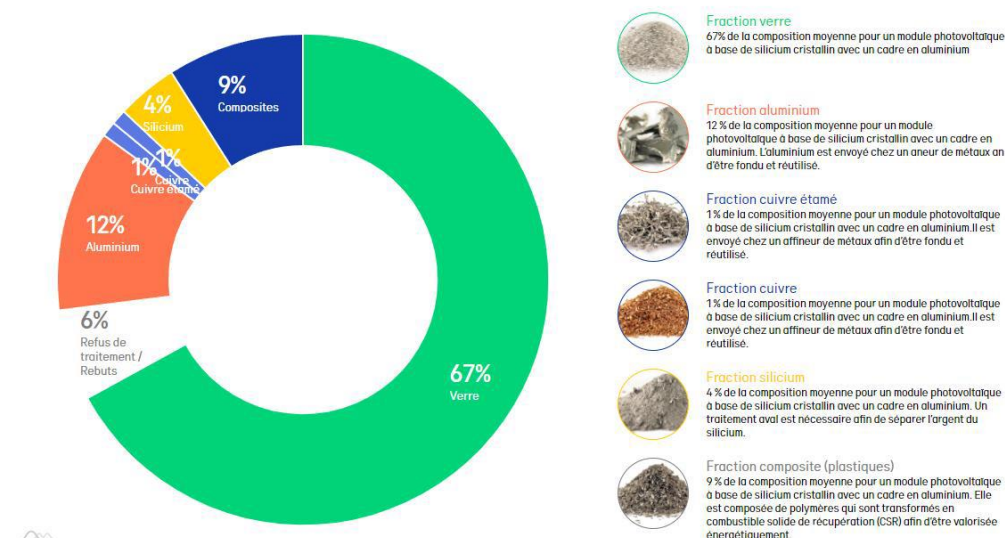
Figure 15 Différentes fractions composant un panneau photovoltaïque (source : SOREN)
