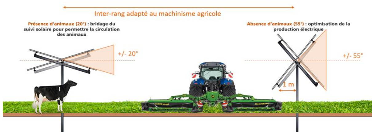
Figure 7 Principe de fonctionnement des trackers
