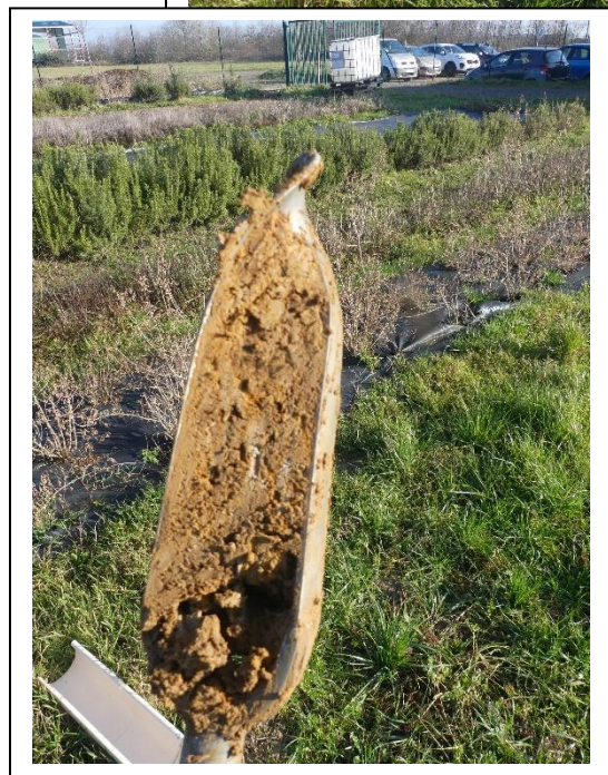
Sondages GP 01 et 02, jardin d'aromatiques, apparition des traits rédoxiques à 40 cm s'intensifiant en profondeur, classe GEPPA IVc, non zone humide
