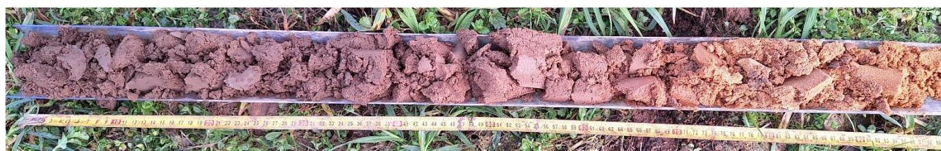
Sondage typique représentatif du sol du site
