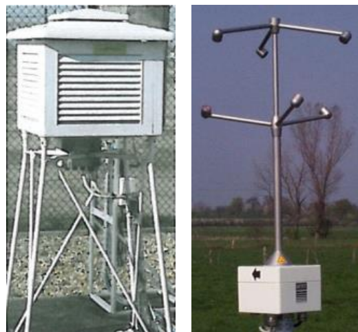
Exemples de matériels pour la mesure de la pluviométrie, de la température et du vent
