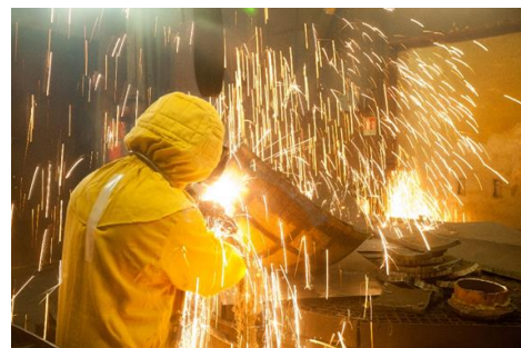
Centraco Cyclife - Découpe thermique avant fusion
