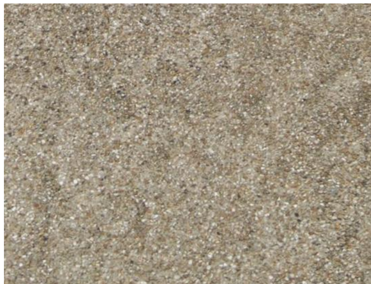
Béton désactivé, reprise de la même formulation que ceux existants (cohérence)
