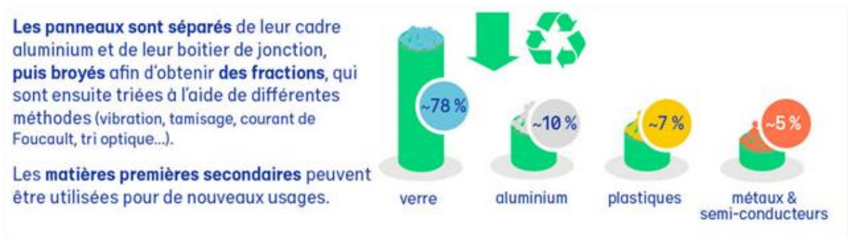
Figure 4 : Procédure de recyclage des panneaux (source : SOREN)
