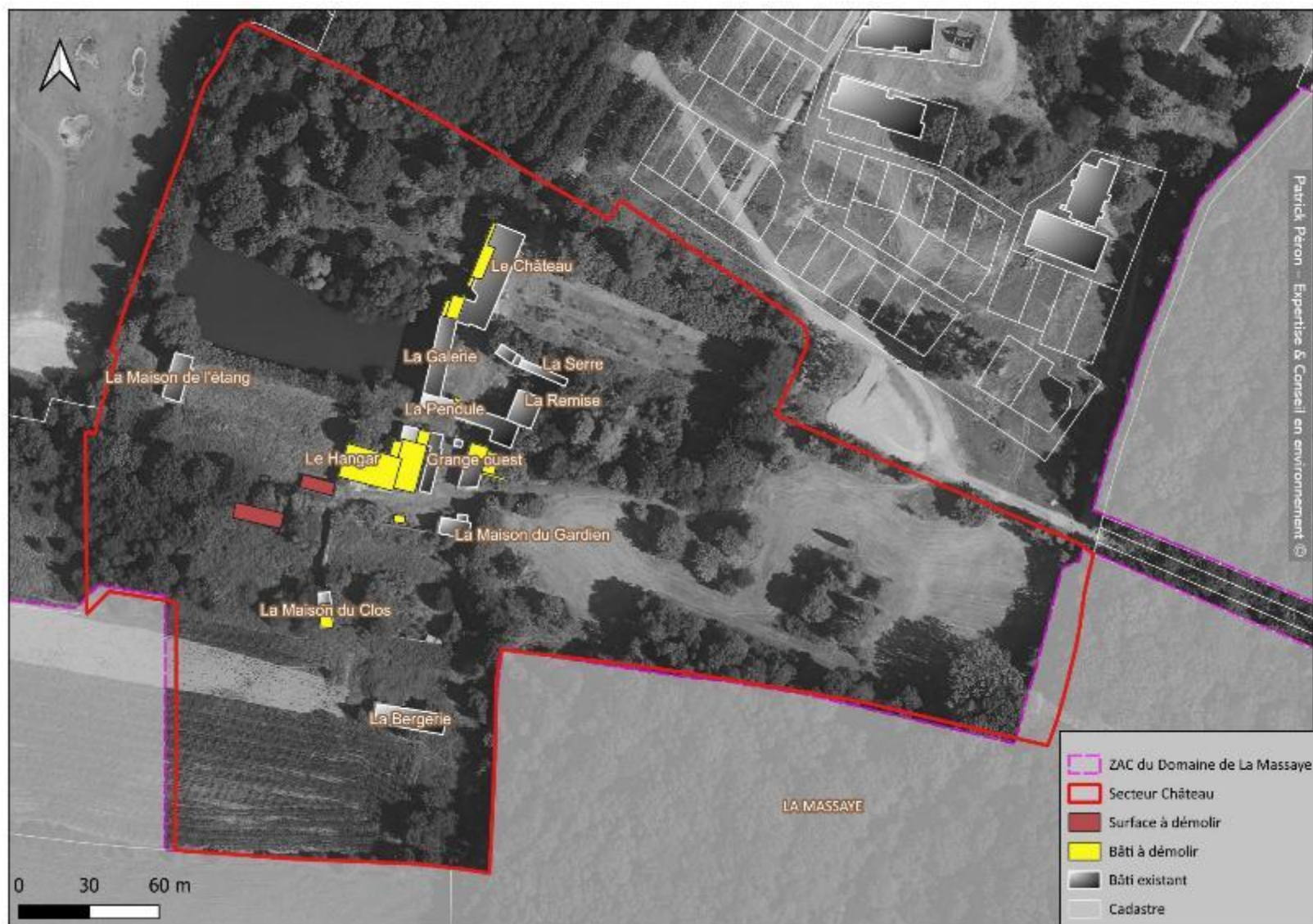
Carte 9 : bâti à démolir
