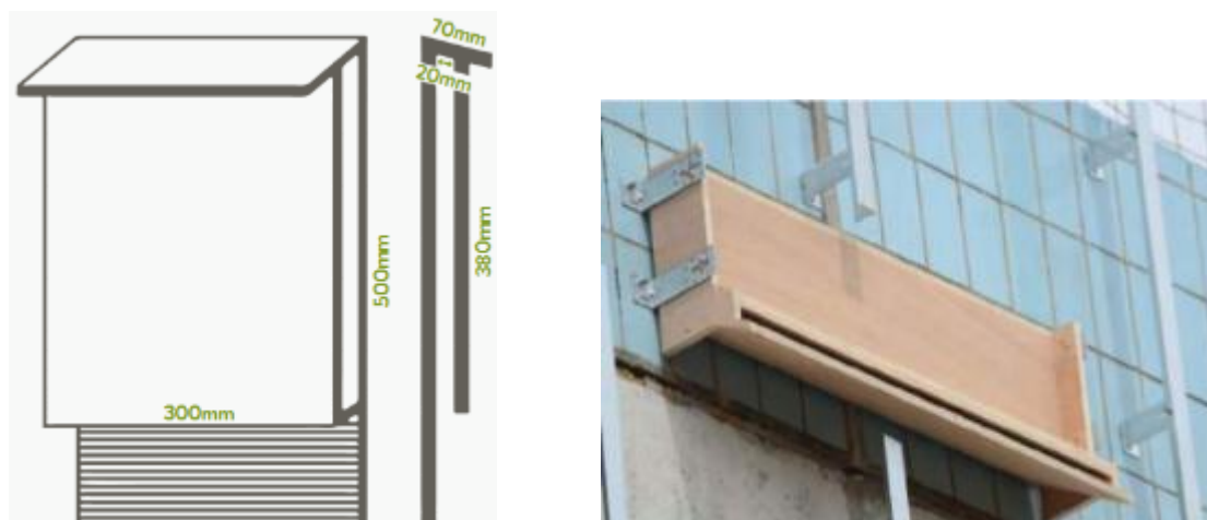
Figure 7 : nichoir à une chambre (© sfepm.org) et caisson avant apposition bardage bois (© L. Arthur Museum de Bourges)
