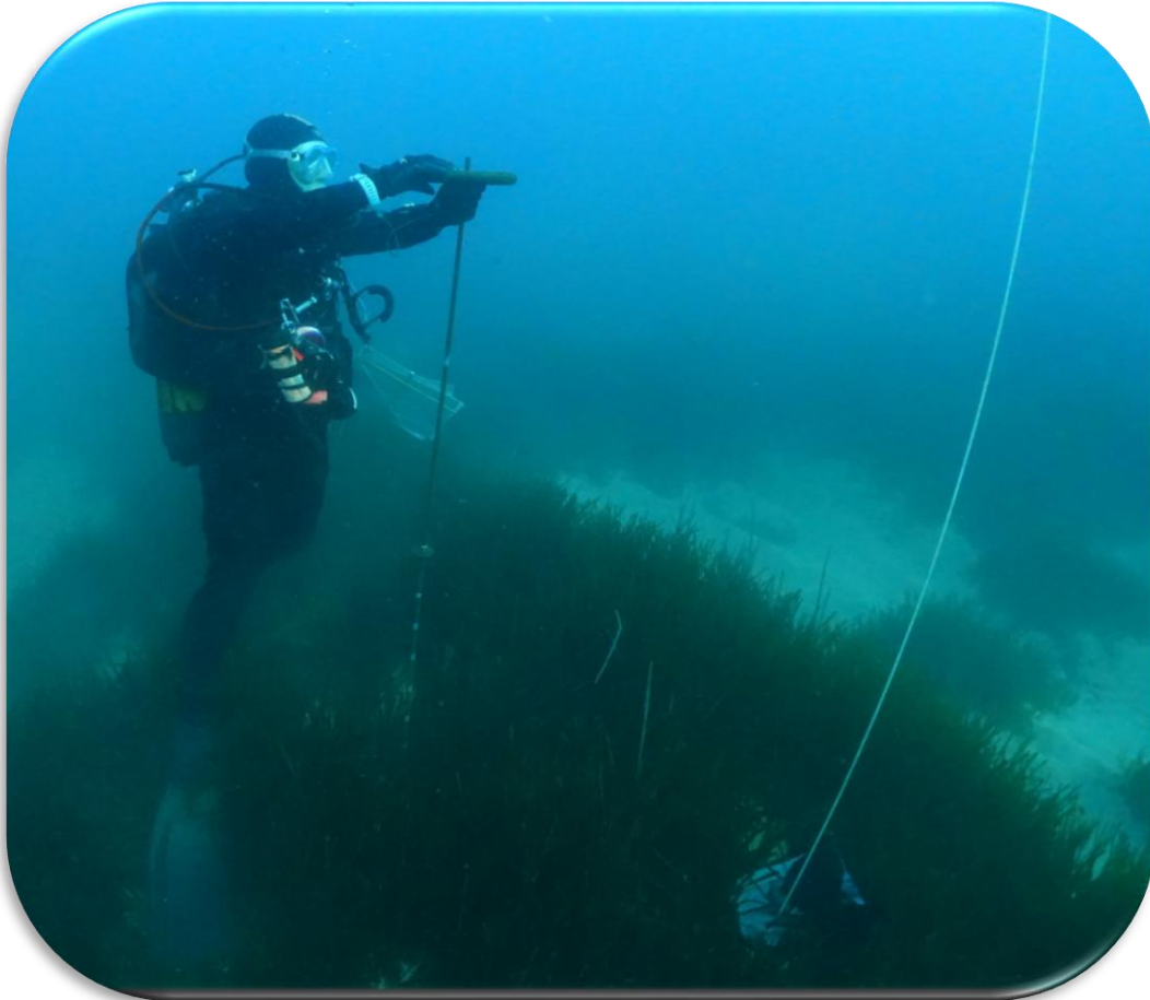
Figure 16 : Réalisation d'un test au pénétromètre en VIT_MOU
