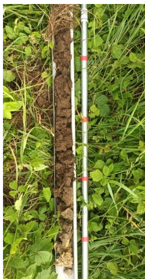
Sondage 2 Observations : Texture sableuse puis limoneuse, horizon rédoxique crayeux à la base
