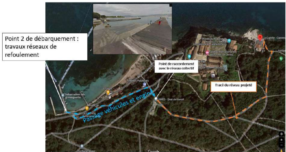
Figure 16: Représentation des 2 points de débarquement et du tracé de l'amenée du matériel en phase travaux - Ciel environnement
